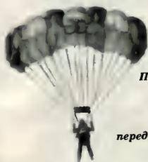
Парашют «Спорт-8»: площадь «крыла» 20 м<sup>2</sup>, горизонтальная скорость передвижения — 12 м/с, вертикальная скорость снижения — 3 м/с, вес — 7 кг.
